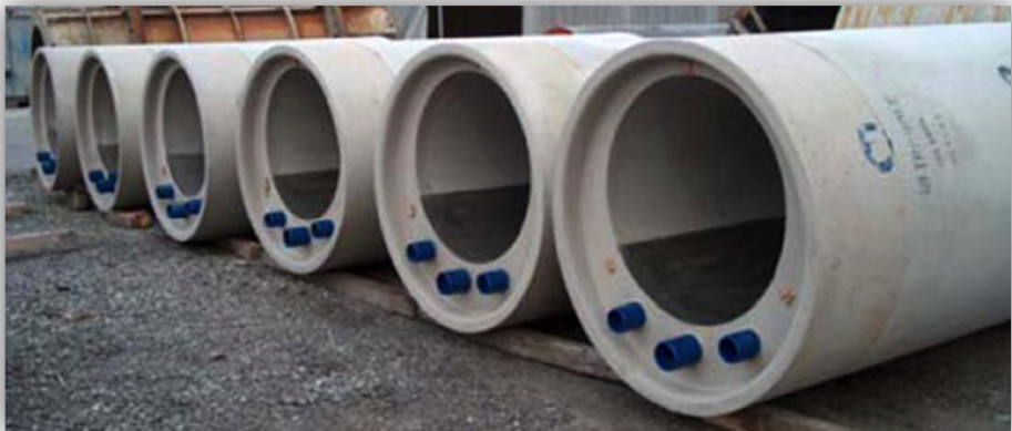
Image 7 - Echangeur de chaleur sur collecteur - Crédit photo: www.actu-environnement.com
