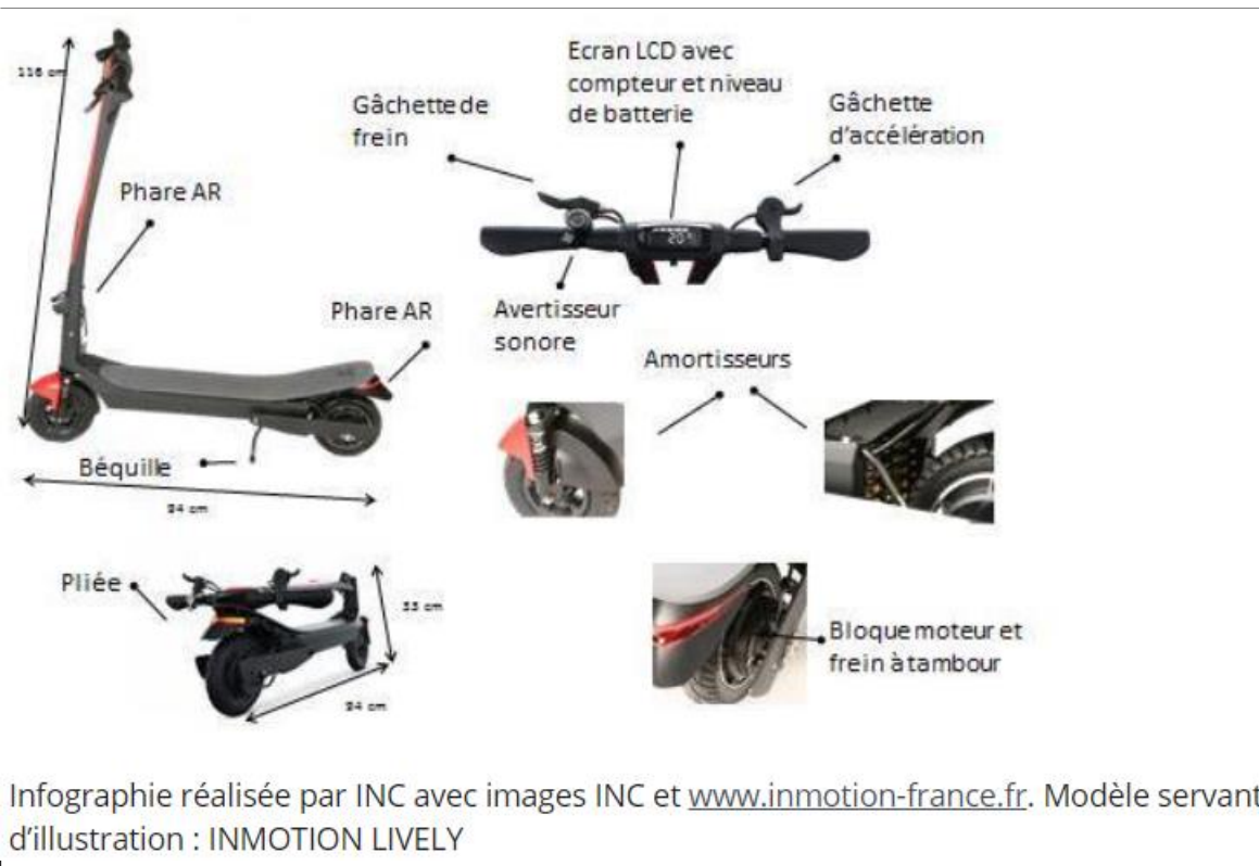
Figure 3.2 – Systèmes de freinage des NVEI
