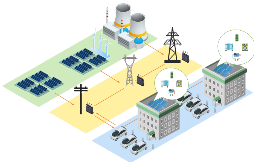
Figure 18. Modalité de couplage des EnR et VE dans copropriétés et Habitat collectif (mono propriétaire)
